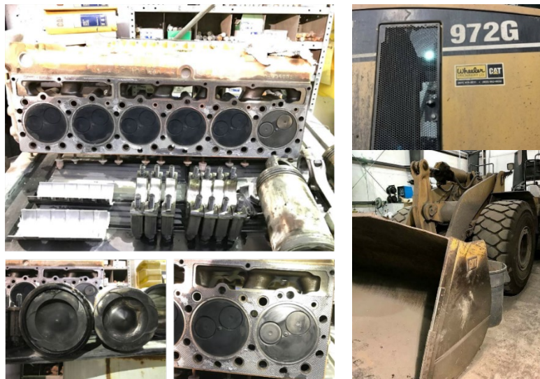
Motor de cargadora CAT 972G desarmado, 10.000 h de mantenimiento (3.000 h utilizando FEROX)
